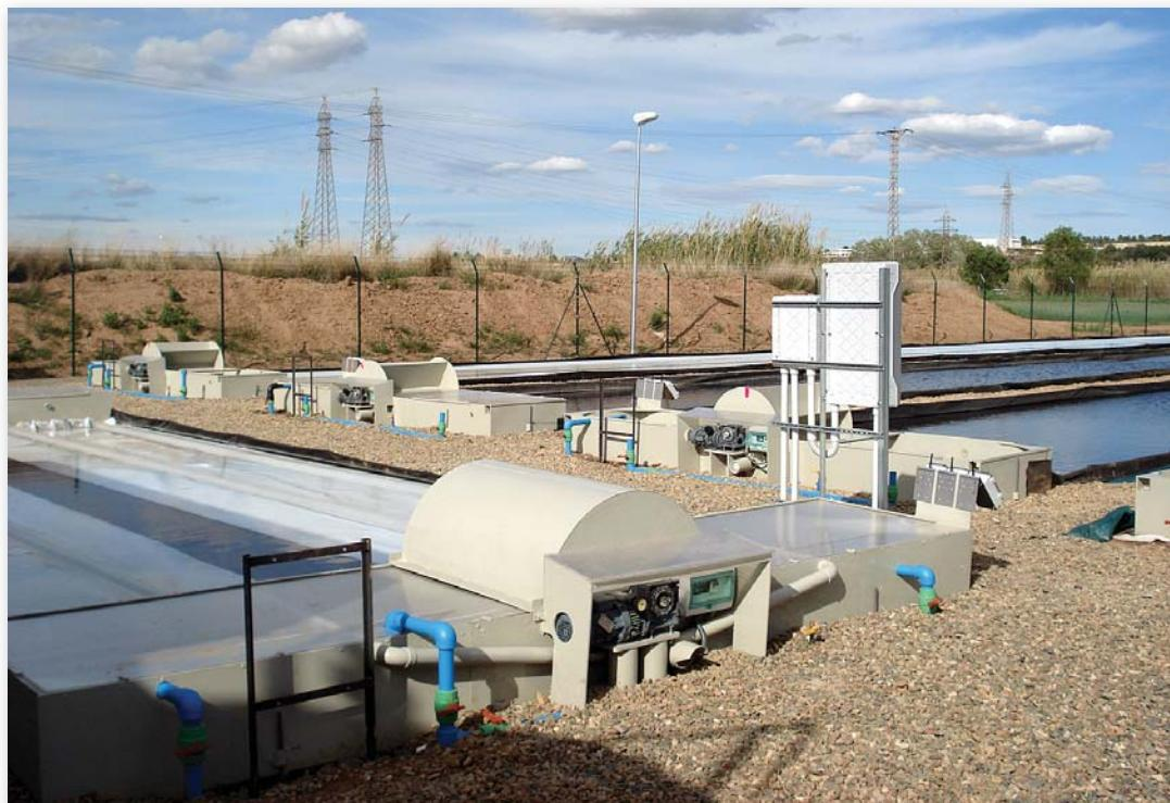
Batería de fotobiorreactores en la refinería de Repsol en Tarragona.
