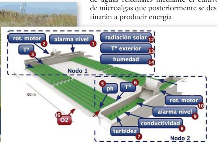
*Fotobioreactor diseñado para la depuración de aguas residuales y esquema con la ubicación de los sensores de control de crecimiento del cultivo y de control del fotobioreactor tubular semicerrado de la UPC.*
